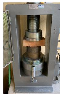
Figura 6 - Teste de resistência à compressão da Amostra 1
