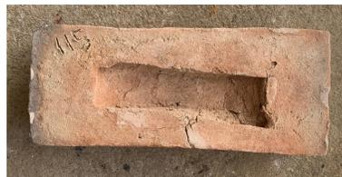
Figura 4 - Tijolo com adição de 115 gramas de resíduo seco
