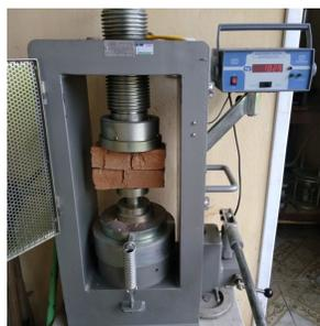
Figura 5 - Teste de resistência à compressão do Tijolo Controle
